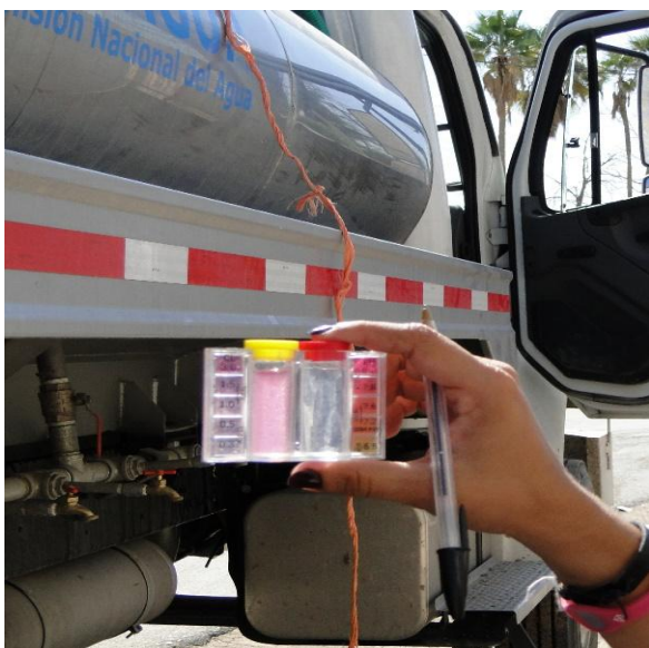
Fig. 2.34 Método de colorímetro para medir el cloro residual en el agua. Fotoarrafía de CCN-A. 2012.
