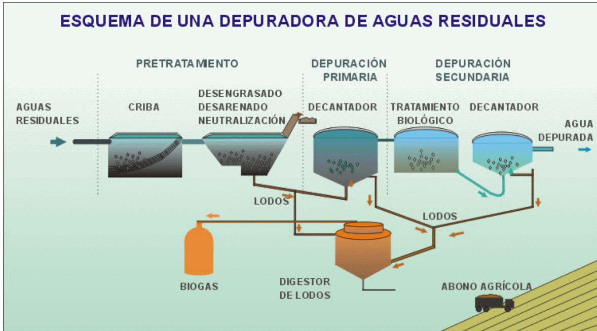
Fig. 5.8 Esquema de una de las formas de tratar las aguas residuales. Fuente: SEMARNAT
